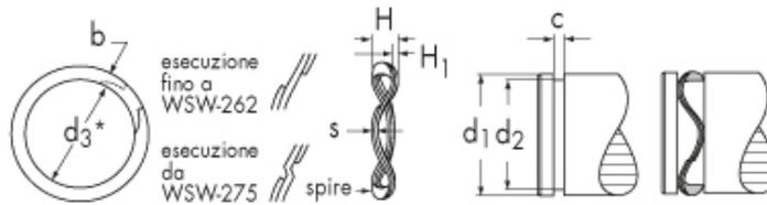
\*d<sub>3</sub> si serra con precisione sul diametro della gola (d<sub>2</sub>)
