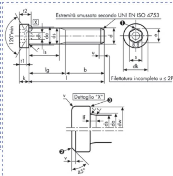
Viti a testa cilindrica bassa con esagono incassato e foro guida
