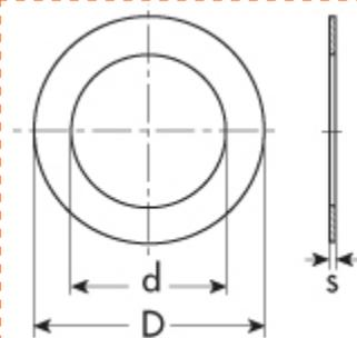
Rondelle di spessoramento tipo **PS** - DIN 988
